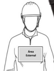
La argolla esternal está especialmente diseñada para conectar un dispositivo anticaídas automático de progresión vertical, utilizado para progresión en torres de telecomunicaciones, de alta tensión y en todo trayecto ascendente o lateral que requiera protección permanente ante los riesgos de trabajos en altura.
